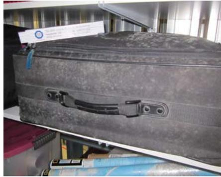
Schimmelpilzbildung an einem Koffer. Ursache ist die hohe relative Raumluftfeuchte und die Schimmelfähigkeit des Lagerguts.
